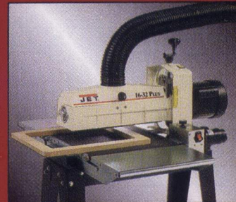
左右を逆にサンディングすれば巾812mmまでの材料が仕上げ可能。
