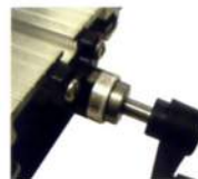
X=Yテーブルを前後左右に動かすハンドルの付け根にも移動量わかる0.1mm単位スケールが付いています。
