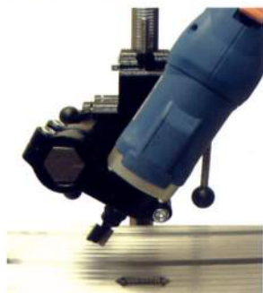
ルーターモーターは垂直だけでなく15度さざみで角度を変えられます。
