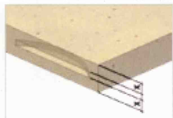
部材の中心への溝加工
