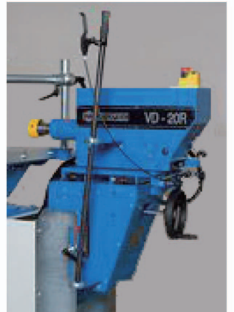
モーター部を前後左右に動かすハンドルには等間隔ドリルガイドピンを操作できるレバーが付いているので、スピーディに多数のダボ穴があげられます。
