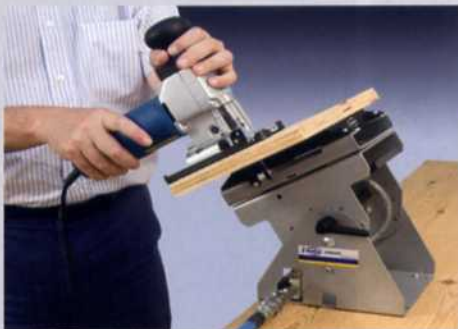
スタンドユニットを使用してジグソー切断
