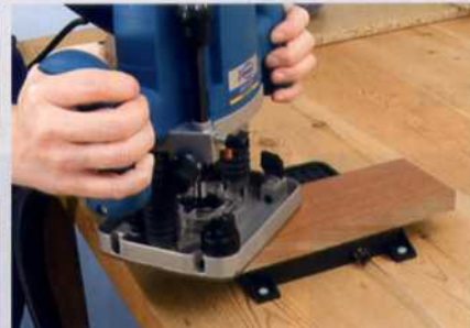
吸着固定ユニットを使用してルーター作業
