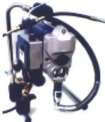
IP395 PRO 一液タイプ電動ポンプ 最大圧力:3,000psi (20.7MPa) 圧力調整機構付 最大吐出量:毎分1.9ℓ 重量:17kg
