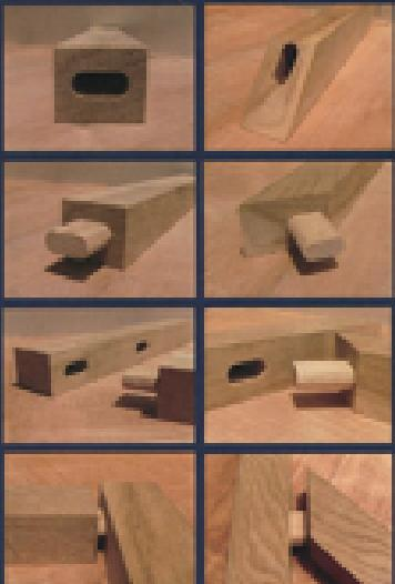
ほぞ組み以外でも、ダボや平ダボ(ビスケット)の代わりにドミノチップを使うこともできます。ブナ材を使用し、最大10mm厚のものまで対応していますので、フラッシュ家具の組み立てでも安心して使えます。
