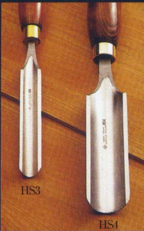
安全で使い易く作業の早い粗削り用のバイトで、角材からの粗削りや大きなカーブの削り出しに向いています。
