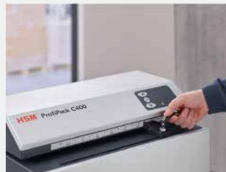
ガイドをスケールの目盛に合わせることで、加工幅を決めて、自由に緩衝材の大きさを調整できます。
