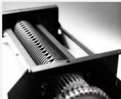
特許を有する一体加工・熱処理されたカッターローラーは長寿命で高耐久です。クリップやホチキスの針などにより刃先が破損しません。
