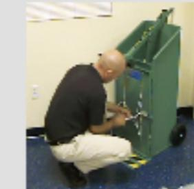
圧縮プレートを上げ、セットしてあったPPヒモ(2本)をフロントドアのスリットに通してから、圧縮プレートを下げ、ロックし、PPヒモでゴミを縛ります。
