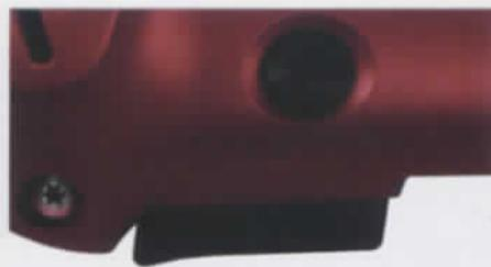
トリガーズイッチの引き具合を変えることで回転スピードがゆっくりと変化します。速度ダイヤル（右隣写真）を 1 にした時には毎分 380 回転から 600 回転の間で変えることができます（ロックボタン付き）。
