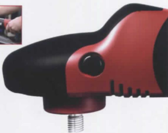
プロトン・シングルのギヤ部は通常のスパイラルベベルギヤの他に、遊星ギヤを採用していますので、高トルクの伝達ができるうえ、小型化を実現しています。更に、ギヤの精度を高めることで、ポリッシングの負荷がかかっても、ギヤ音を極力小さくできました。
