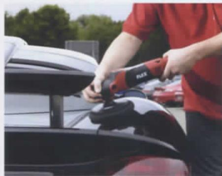
プロトン・シングルはヘッド部が操作しやすいように低く、全体の重量バランスが良いので、複雑なボディ表面もスムーズにポリッシングできます。
