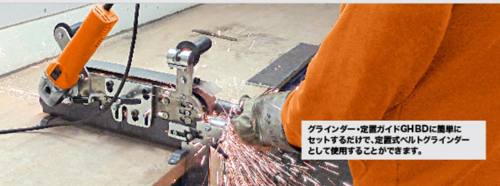
グラインダー・定置ガイドGHBDに簡単にセットするだけで、定置式ベルトグラインダーとして使用することができます。
