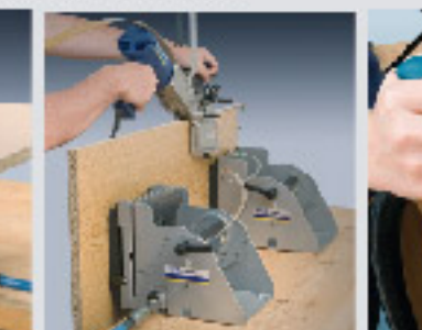
補助スタンドユニット SVN470 を追加して、大きな板材の縁取り作業
