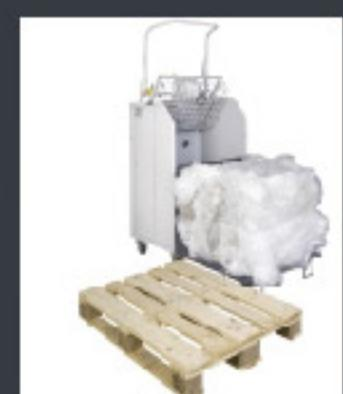
コンテナのフロントパネルを前に倒して、圧縮減容されPPヒモが掛けられたストレッチフィルムを引き出します。
