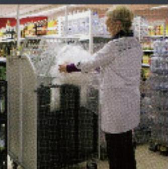
V-Press 60は梱包資材ゴミが発生する場所へ移動しながら、収集し、圧縮減容できますので、梱包資材ゴミの一時保管場所が必要なくなります。
