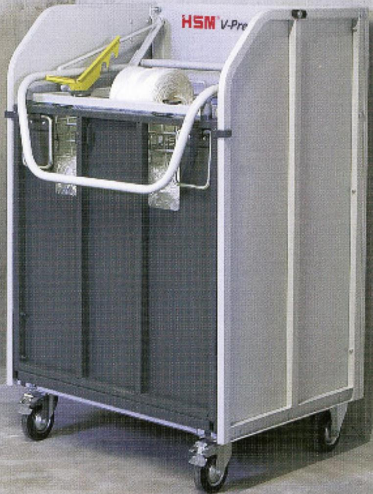
廃棄すべき梱包資材ゴミ(ストレッチフィルム、ビニール袋、紙袋、包装紙、巻ダンボール、紙箱、エアークッション、PPバンドなど)が発生している場所で移動収集しながら、 $\frac{1}{5}$ 以下に圧縮減容し、一時保管ができます(圧縮後の体積0.48立方メートル=480リットル、重量40kgまで)。一時保管場所を縮小できるばかりでなく、ゴミ処理費用を大巾に削減できます。
