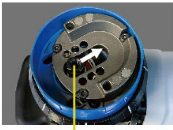
調整リングを回しますとパッドが取り付いている
